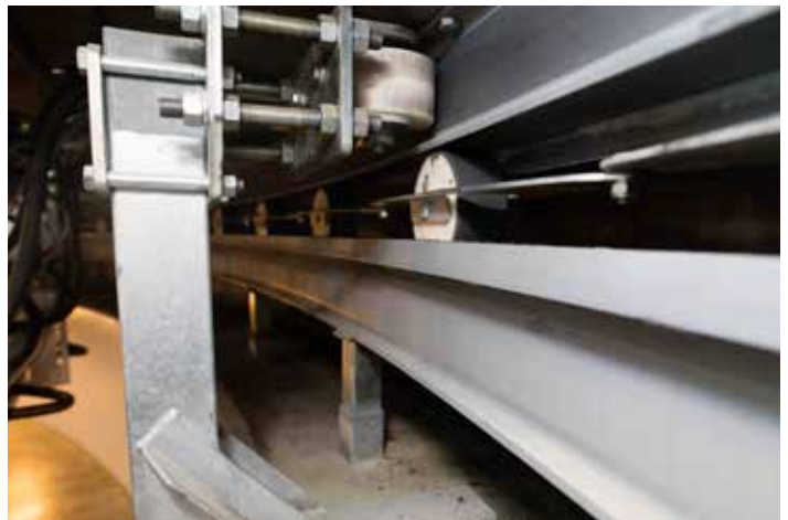
Sistema de giro com carga pontual reduzida.
