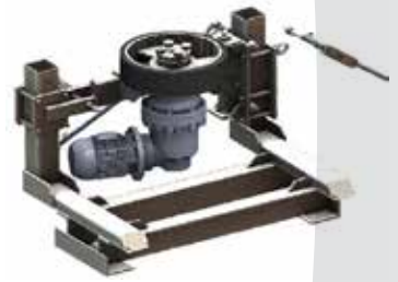
Sistema de acionamento.
