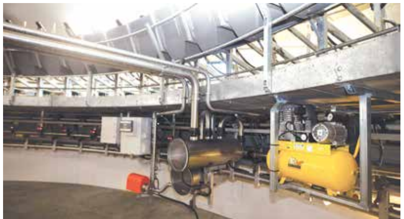
Sistema de ordenha instalado sob a plataforma GEA DairyRotor T8590.
